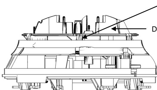
Rysunek 3 Prawidłowa pozycja termistora po ponownym złożeniu czujki.
