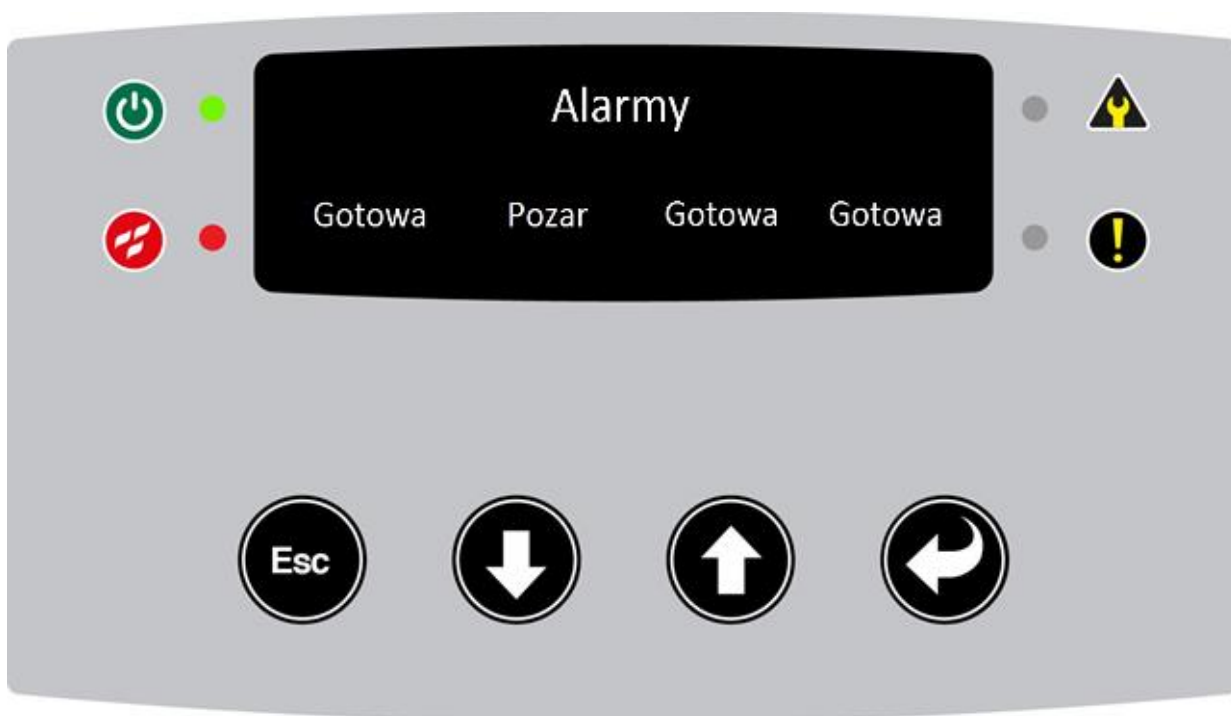
Rysunek 4.4 Stan alarmu pożarowego w czujce ProPointPlus
